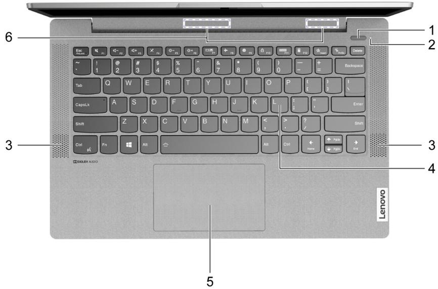
Abbildung 2. IdeaPad 5 (14", 05), IdeaPad Slim 5 (14", 05) und Lenovo Ducati 5 - Ansicht des Unterteils
