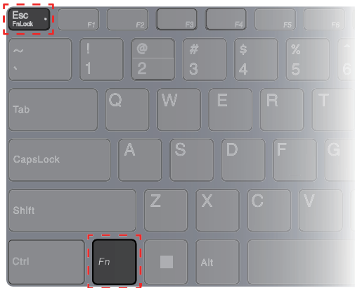
Abbildung 2. Positionen der FnLock-Taste und der Fn-Taste
