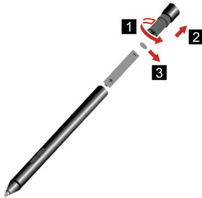
Abbildung 1. Entfernen des Isolierkissens
