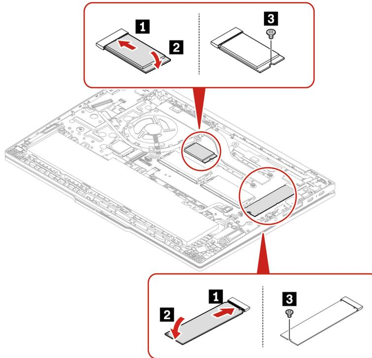
Schritt 2. Installieren Sie das M.2 Solid-State-Laufwerk in umgekehrter Reihenfolge.
