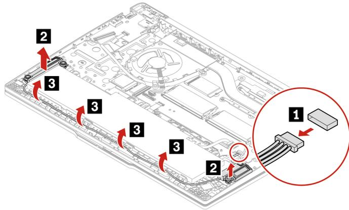
Schritt 2. Installieren Sie die Baugruppe in umgekehrter Reihenfolge.
