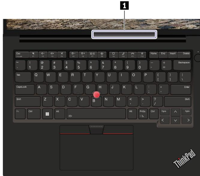
1 Antenne für drahtlose LAN-Verbindungen
