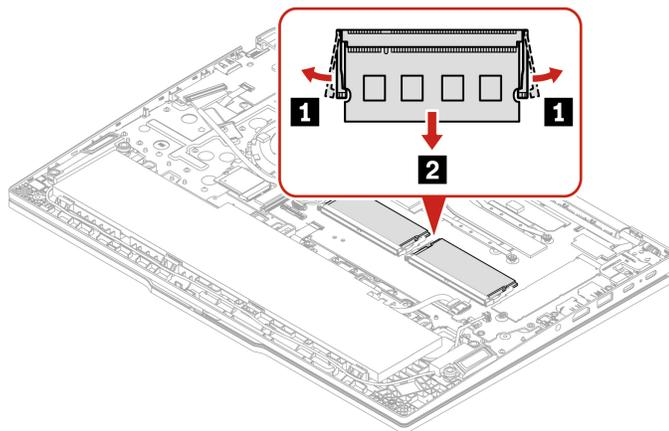
Schritt 2. Setzen Sie das Speichermodul ein wie unten gezeigt
