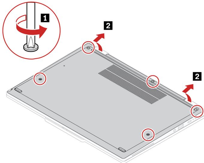
Schritt 2. Befestigen Sie die Baugruppe für die Abdeckung wie unten dargestellt.
