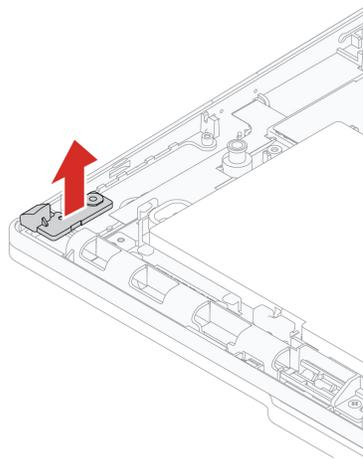
Schritt 2. Installieren Sie die Stiftattrappe in umgekehrter Reihenfolge.
