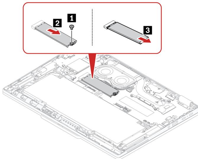
Schritt 2. Installieren Sie das M.2 Solid-State-Laufwerk und die M.2 Solid-State-Laufwerkshalterung in umgekehrter Reihenfolge.
