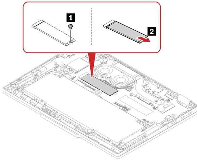
Schritt 2. Installieren Sie das M.2 Solid-State-Laufwerk in umgekehrter Reihenfolge.
