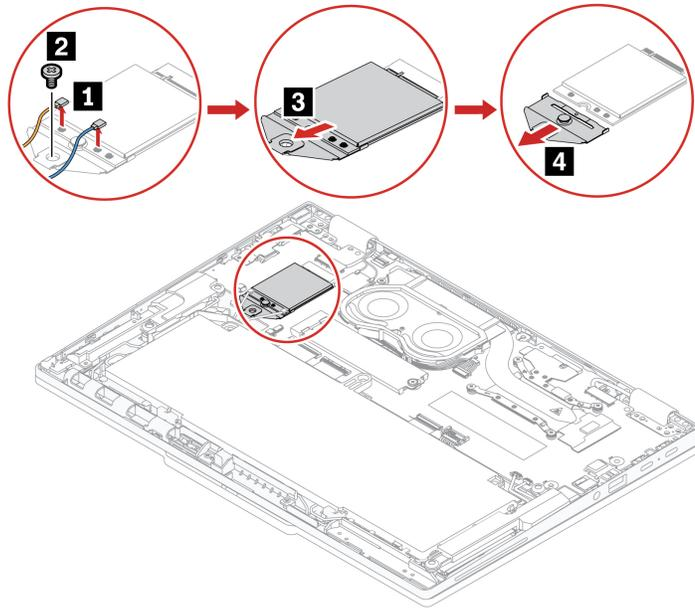
Schritt 2. Installieren Sie die Wireless WAN-Karte und die Halterung für die Wireless WAN-Karte in umgekehrter Reihenfolge.
