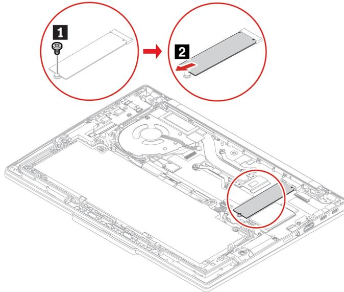
Schritt 2. Installieren Sie das M.2 Solid-State-Laufwerk in umgekehrter Reihenfolge.
