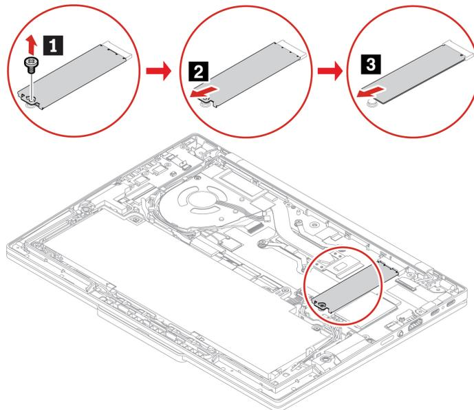
Schritt 2. Installieren Sie das M.2 Solid-State-Laufwerk und die M.2 Solid-State-Laufwerkshalterung in umgekehrter Reihenfolge.
