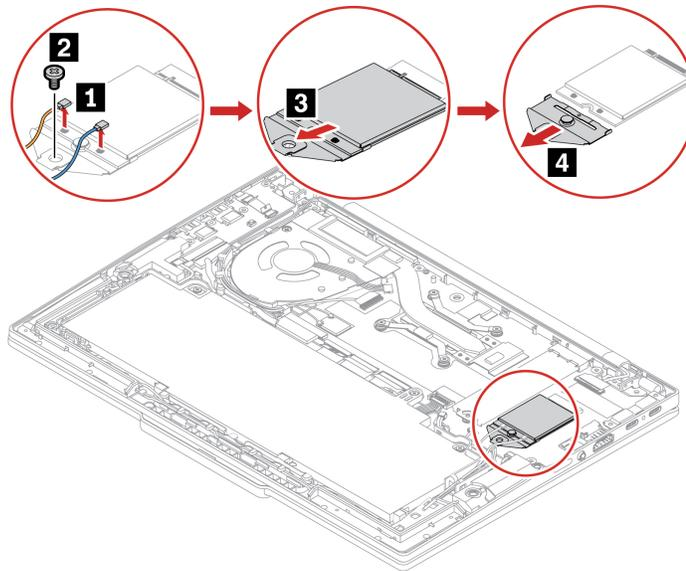
Schritt 2. Installieren Sie die WWAN-Karte und WWAN-Kartenhalterung in umgekehrter Reihenfolge.
