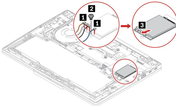
Schritt 2. Installieren Sie die WWAN-Karte in umgekehrter Reihenfolge.
