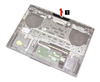
Figure 40. Remove the thermal fin
