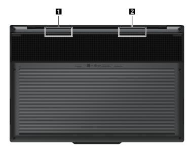
Antenne für drahtlose LAN-Verbindungen (Hilfsantenne)
