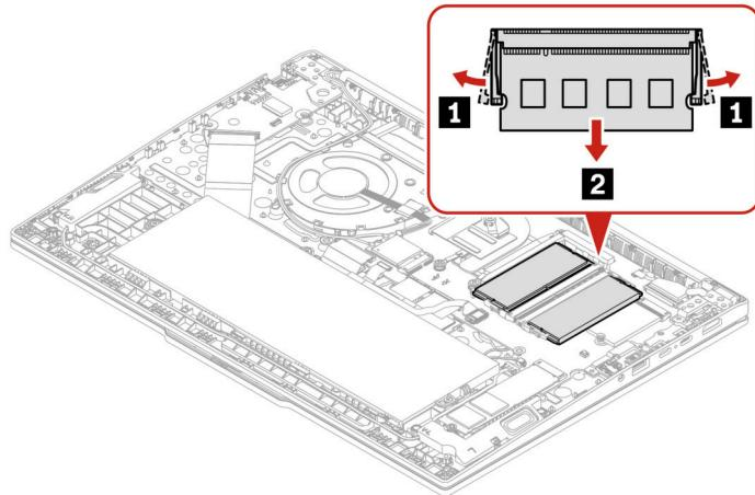
Schritt 2. Installieren Sie das Speichermodul wie unten dargestellt.
