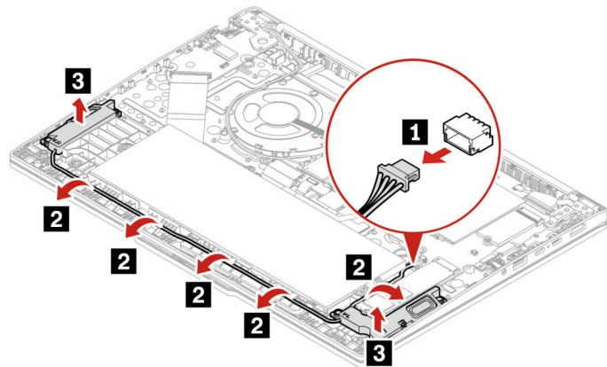
Schritt 2. Installieren Sie die Lautsprechereinheit in umgekehrter Reihenfolge.
