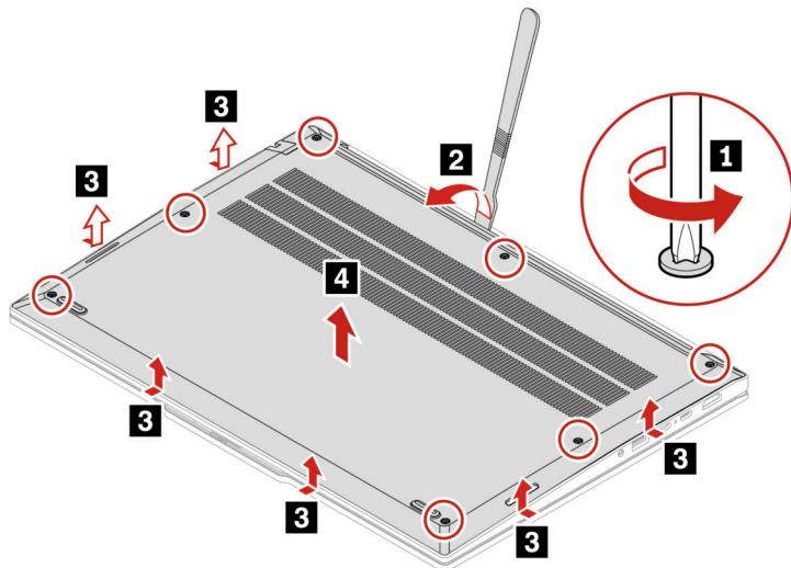
Schritt 2. Installieren Sie die Baugruppe der unteren Abdeckung in umgekehrter Reihenfolge.
