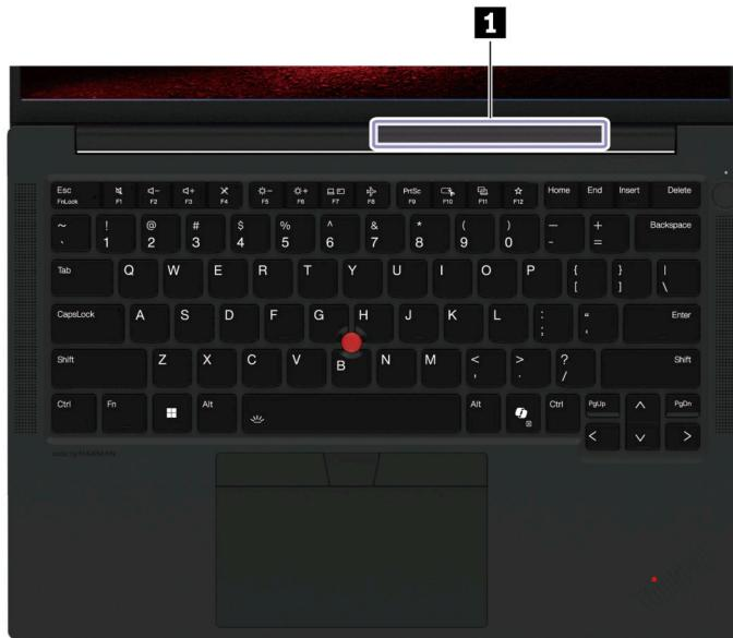
**1** Antenne für drahtlose LAN-Verbindungen
