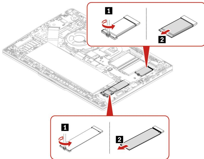
Schritt 2. Installieren Sie das M.2-Solid-State-Laufwerk und dessen Halterung wie in der folgenden Abbildung dargestellt. Ziehen Sie die unverlierbare Schraube an, um das M.2 Solid-State-Laufwerk zu befestigen.
